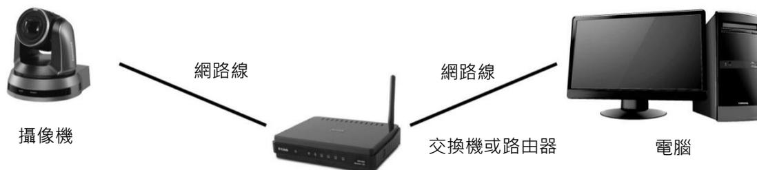
2. 通過網路線直接連接，須修改電腦之 IP 位址同攝像機使用之網段
